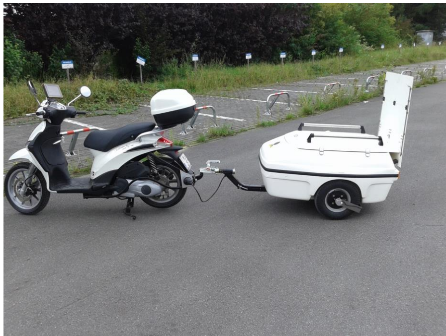
Photo 1 Mesure de l'uni longitudinal des pistes cyclables (source: CRR)
